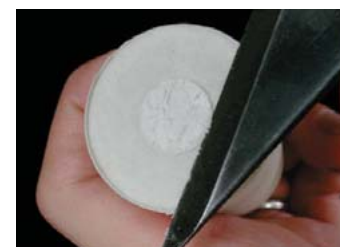
Снимите «головку» формовочной массы, образованную выравнивающей крышкой
