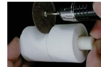
Разрезание с помощью сепарационного диска
