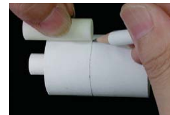
Маркировка верхнего положения плунжера
